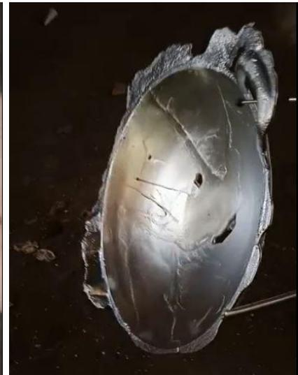
Pada gambar di atas merupakan proses pencetakan wajan yang dimulai dengan menuangkan logam cair ke dalam cetakan dan setelah logam cair membeku kemudian dilepaskan dari cetakan. Dari pelaksanaan kegiatan ini secara langsung dihasil produk wajan walaupun masih memerlukan pekerjaan lanjutan berupa finising dengan mengamplas pada permukaan wajan yang masih ada serpihan-serpihan logam.
